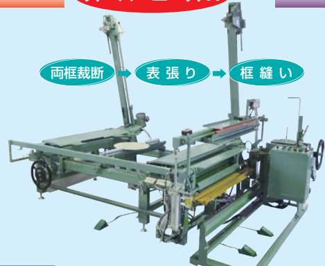
No.6R 両框自動裁断付自動表張り框縫機 空圧/電動式 型式/SSR-RMSS型
